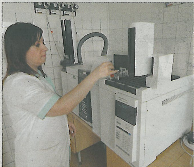
Plynový chromatograf s headspace nástřikem a FID detektorem pro stanovení těkavých relevantních nečistot v přípravcích na ochranu rostlin
