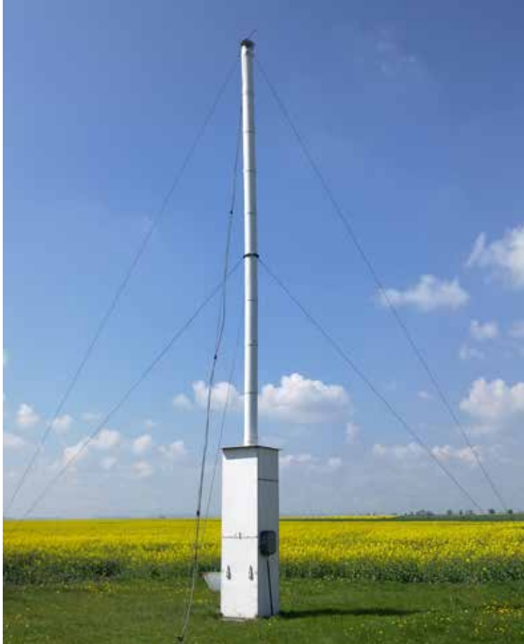
▲ Sací past v Žatci, dle anglické konstrukce Johnson-Taylor (výška 12,2 m). Foto D. Fryč
