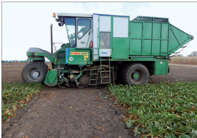
Obr. 6. Sklizeň strojem MORELAB 4 postaveným na základě Stoll V300 SF
