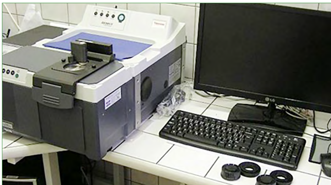
NIR spektrometr pro reflektanční měření pevných vzorků.
