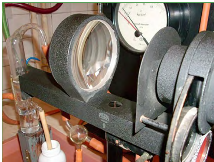
Plamenový fotometr byl využíván pro stanovení draslíku v extraktech půd podle Shachtschabela.
