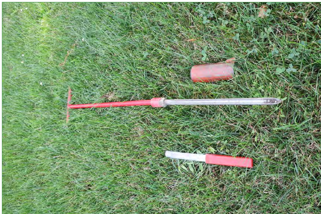
Sondovací tyč pro odběr půdních vzorků do 30 cm.
