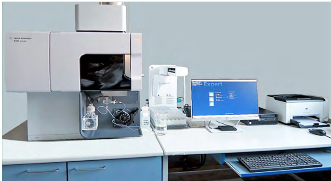
Simultánní optický emisní spektrometr s indukčně vázaným plazmatem ICP OES 5100 VDV (Agilent Technologies) na pracovišti NRL ÚKZÚZ v Opavě.
