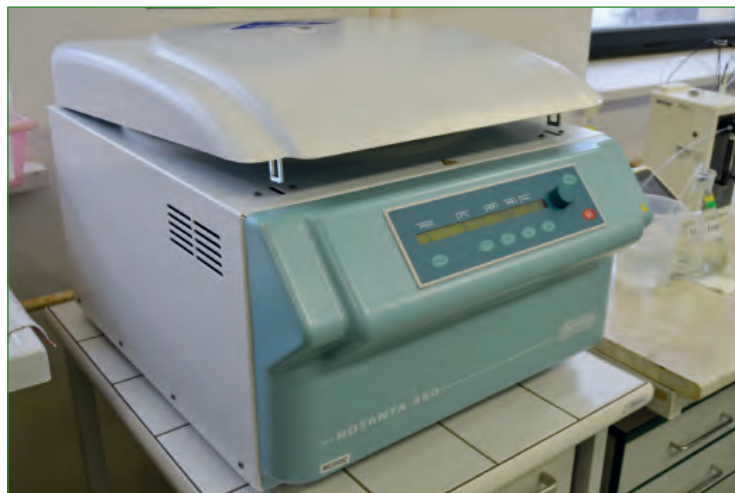
Velkoobjemová centrifuga Rotanta 460 je v laboratořích ÚKZÚZ používána pro přípravu extraktů půd podle Mehliche 3.
