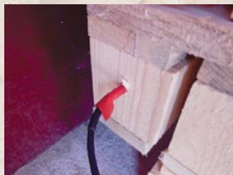
Obr. č. 12 Sondu je třeba po umístění do dřeva utěsnit, aby nedocházelo ke zkreslení měření.
