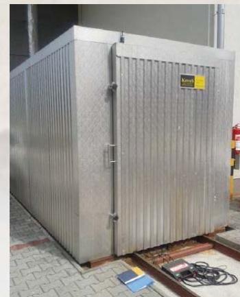
Obr. 1 Komora k tepelnému ošetřování dřeva se zařízením k měření teplotního průběhu ošetřování.
