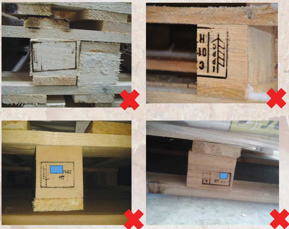
Obr. č. 19 Chybně označený DOM, který nesplňuje podmínky standardu. Dovážející země může přistoupit k opatřením, které zahrnují ošetření, zničení nebo vrácení DOM (i se zbožím).
