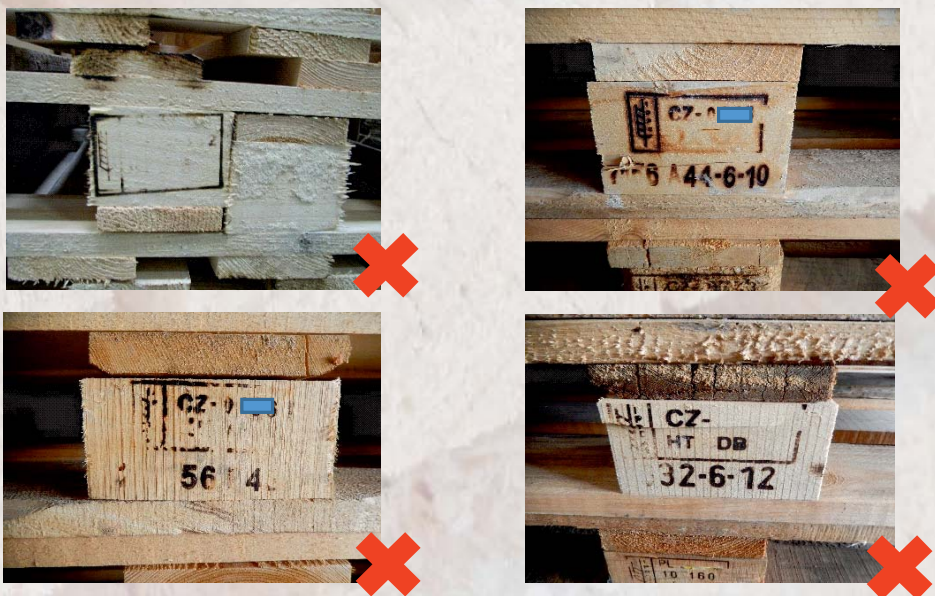
Obr. 22 Chybně provedené značení.
