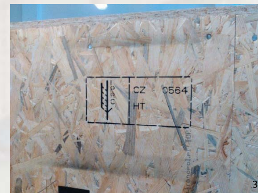
Obr. č. 18 Různé způsoby značení DOM – vypalovací raznice (1), razítko (2), nástřik přes šablonu (3).
