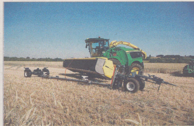
Další novinkou pro rok 2020 je u sklízecích řezaček aktivní ovládání adaptéru rozšířené o boční náklon
