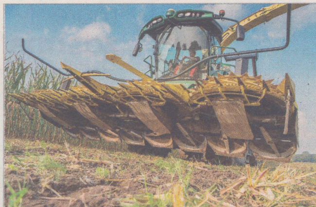
Systém StalkBuster je zkonstruován tak, aby narušil strniště přímo pod adaptérem samojízdné řezačky, čímž zlikviduje přirozené prostředí pro přezimování zavíječe kukuřičného a sníží riziko výskytu fuzarií v půdě. Není tak již třeba následné mulčování
